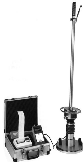
**3.0205**      **Устройство для исследования грунта модель LFG**
