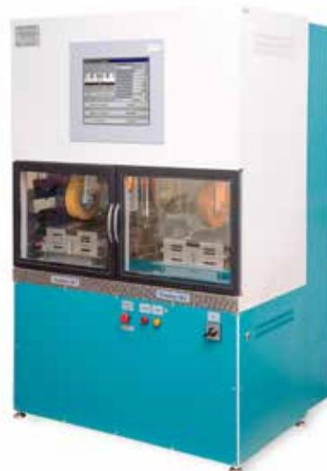
Цветной сенсорный дисплей 17 дюймов обеспечивает вывод подробной информации о заданных условиях испытания, текущих значениях нагрузки на колёсах и измеренных значений во время испытания, а также график колееобразования.
