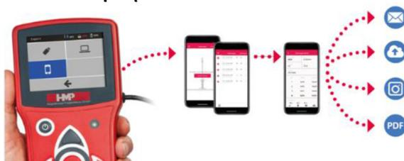
С помощью бесплатной программы HMPtransfer, установленной на смартфон или планшет, можно скопировать данные с прибора HMP LFG. Затем данные можно переслать по электронной почте или другим способом на компьютер с установленным ПО (модели с ПО). Нет необходимости физически перемещать прибор или накопитель USB. HMPtransfer также может создавать краткий отчёт для просмотра на месте работ.
