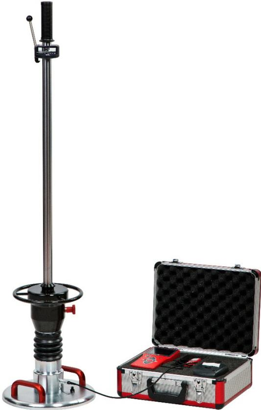
Прибор является универсальным, так как может применяться повсюду, где необходимо соблюдать требования к механической нагрузке на грунт, к примеру, в дорожном строительстве, при прокладке кабелей, трубопроводов, при строительстве фундаментов и железных дорог. Данное устройство просто в применении, может обслуживаться одним человеком, результат измерений может быть получен в течение 3-х минут.
