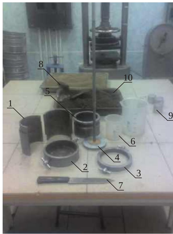
Рис. 4.65. Приборы и оборудование: 1 – 3 – цилиндрическая часть, поддон и зажимное кольцо формы; 4 – штанга, для груза; 5 – насадка; 6 – мерные цилиндры; 7 – нож; 8 – шпатель; 9 – бюксы; 10 – металлические чашки с грунтом
