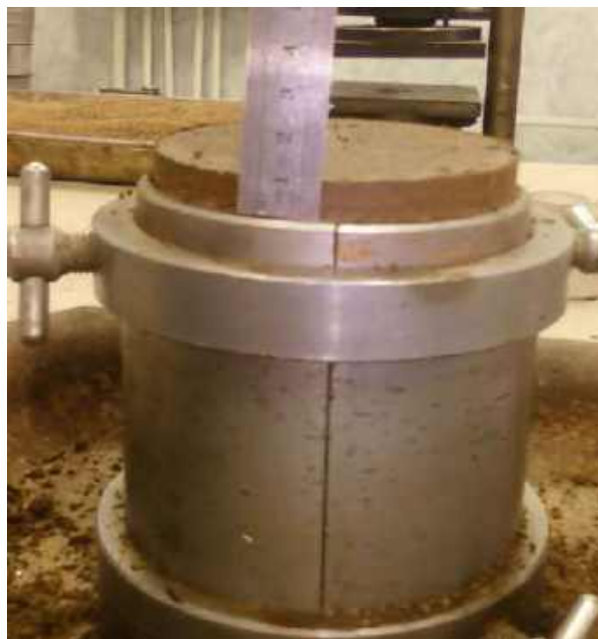
Рис. 4.74. Измерение и контроль высоты выступающей части грунта
