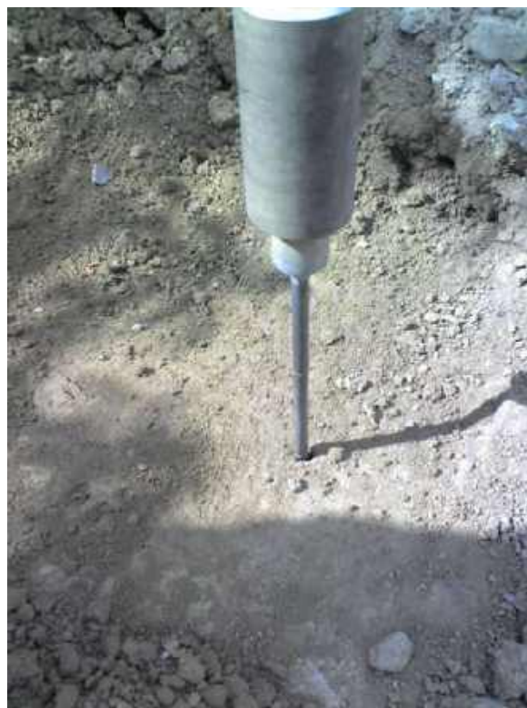
Рис. 4.156. Погружение стержня с наконечником на 20 см (до нижней риски)
