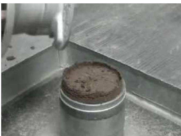
Рис. 4.51. Общий вид выступающей части грунта по завершению теста A
