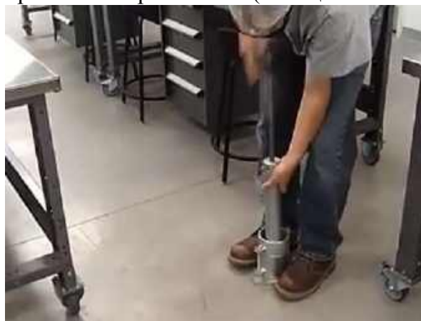
Рис. 4.42. Шестой удар ручной трамбовки при тесте B (кольцевая схема)
