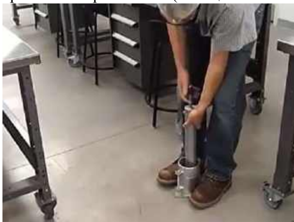
Рис. 4.41. Пятый удар ручной трамбовки при тесте B (кольцевая схема)
