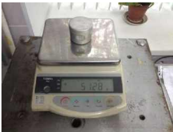
Рис. 3.7. Взвешивание стаканчика с грунтом и крышкой
