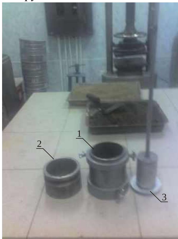
Рис. 4.64. Установка для испытания грунта методом стандартного уплотнения СоюздорНИИ: 1 – форма для образца грунта; 2 – насадка; 3 – устройство для ручного уплотнения грунта с грузом массой 2500 г
