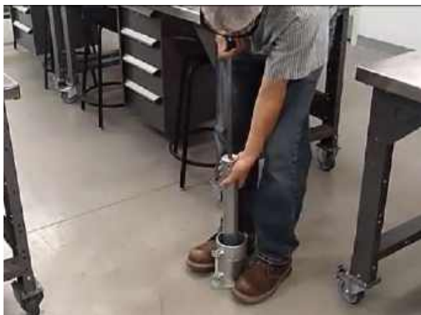
Рис. 4.37. Первый удар ручной трамбовки при тесте B (кольцевая схема)
