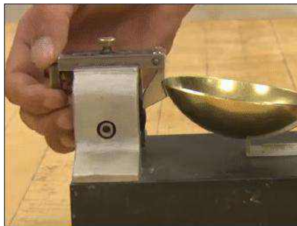
Рис. 3.25. Фиксация чашки зажимными винтами на высоте 10 мм
