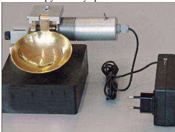
Рис. 3.23. Прибор А. Казагранде с электрическим двигателем падения чашки, обеспечивая требуемые 10 мм.
