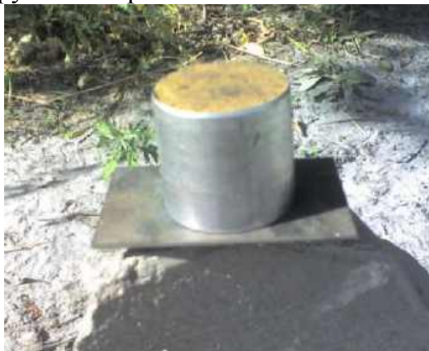
Рис. 4.91. Зачищенная поверхность грунта в кольце
