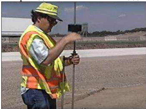
Рис. 4.146. Подбивка места соединения стержней двумя-тремя ударами груза, сбрасываемого с высоты 10 – 20 см
