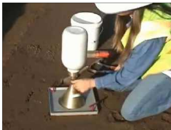
Рис. 4.124. Открытие заслонки для засыпки лунки песком
