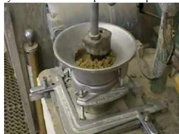
Рис. 4.46. Пятый удар полуавтоматической трамбовки при тесте А
