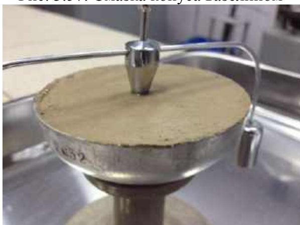
Рис. 3.59. Погружение конуса в пасту под действием собственного веса
