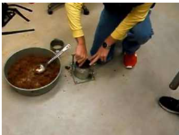
Рис. 4.15. Проверка контакта цилиндрической части и опорной пластины
