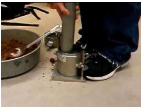
Рис. 4.33. Первый удар ручной трамбовки при тесте А (схема рис. 4.31)
