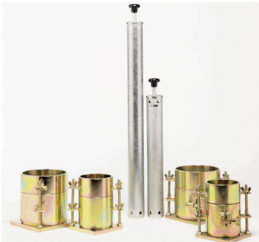
Рис. 4.5. Приборы Проктора с ручными трамбовками для выполнения тестов A , B и C стандартным и модифицированным методами
