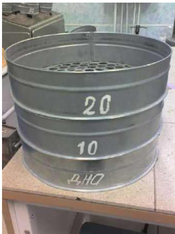
Рис. 4.66. Рассев грунта сквозь сита № 20 и № 10
