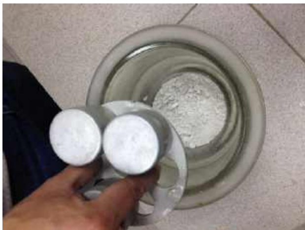
Рис. 3.9. Иллюстрация охлаждения образцов в эксикаторе с \text{CaCl}_2
