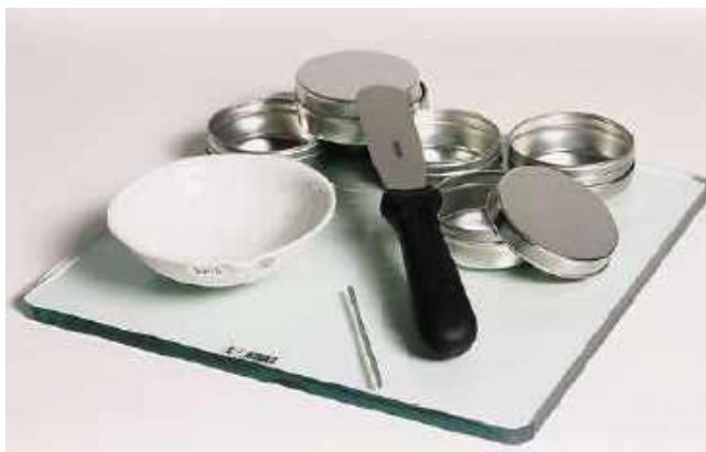
Рис. 3.39. Инвентарь, необходимый для определения предела пластичности грунта по стандарту ASTM D 4318 [48]
