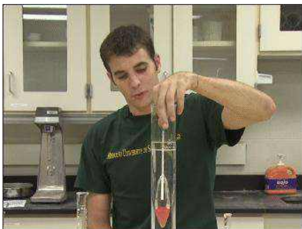
Рис. 3.81. Размещение ареометра в воде температурой 20 °С
