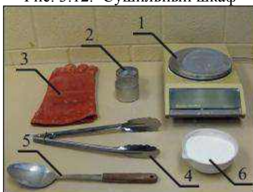
Рис. 3.13. Оборудование: 1 – весы класса GP1; 2 – бюкса; 3 – перчатка; 4 – щипцы; 5 – ложка; 6 – чашка с грунтом
