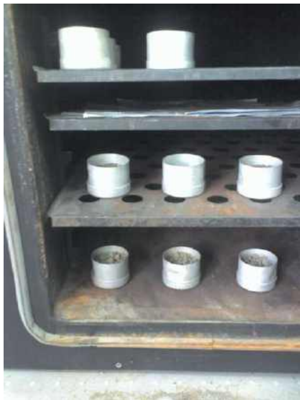
Рис. 4.79. Высушивание проб грунта до постоянной массы при определении влажности
