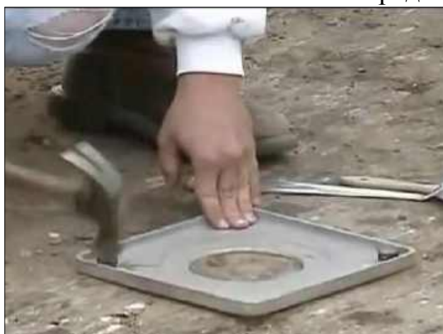
Рис. 4.133. Крепление листа основания штырями, забиваемыми в грунт
