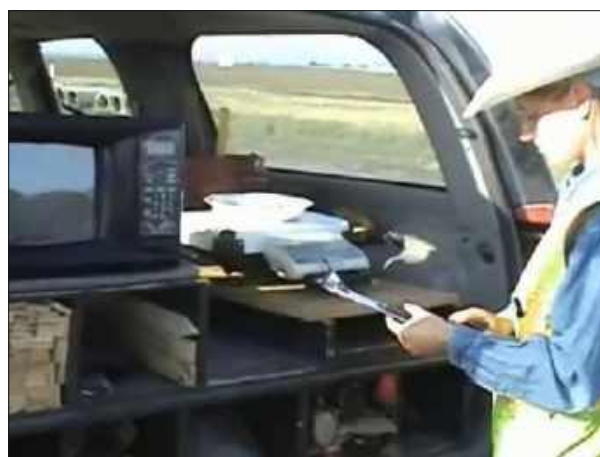
Рис. 4.132. Взвешивание грунта после сушки
