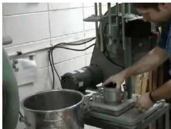
Рис. 4.24. Установка цилиндрической части на основание пресс-формы
