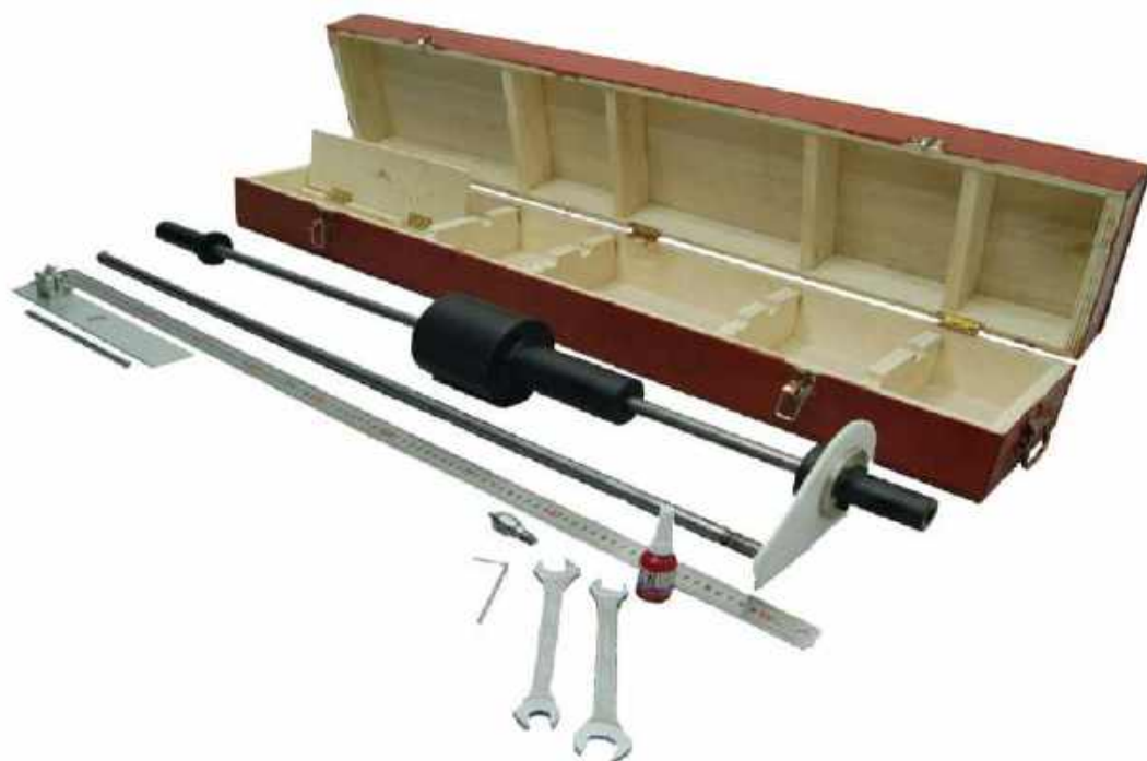
Рис. 4.143. Составные части оригинального динамического конусного пенетromетра и футляр для хранения и транспортирования прибора
