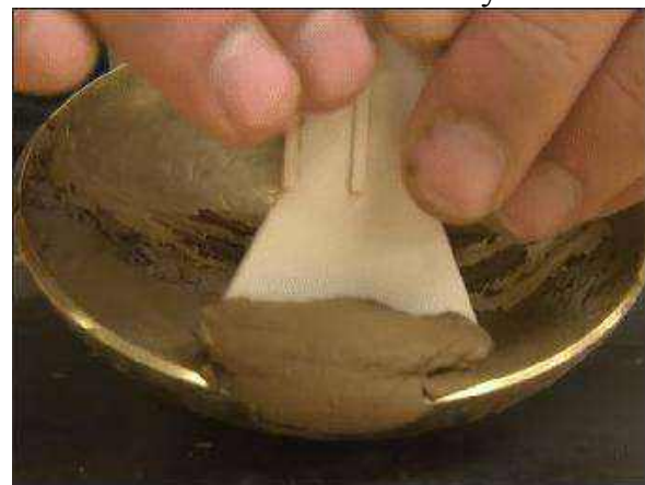
Рис. 3.31. Устройство борозды V-образным шпателем
