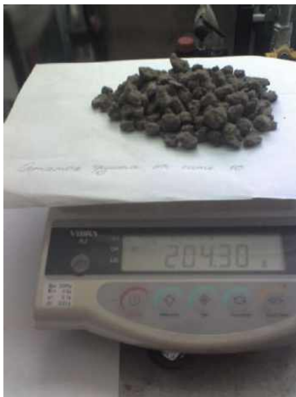
Рис. 4.67. Взвешивание частиц, оставшихся на сите № 10
