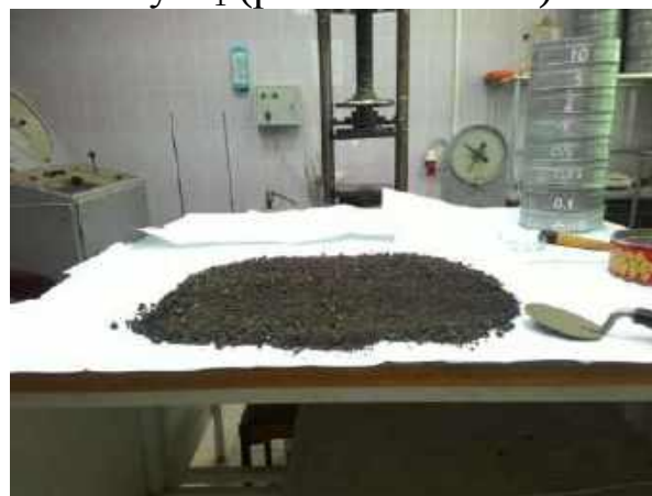
Рис. 3.76. Грунт, выровненный слоем в квадрат для разделения на четверти
