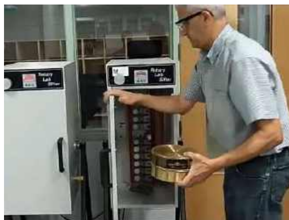
Рис. 4.8. Рассев пробы с применением вибрационного оборудования
