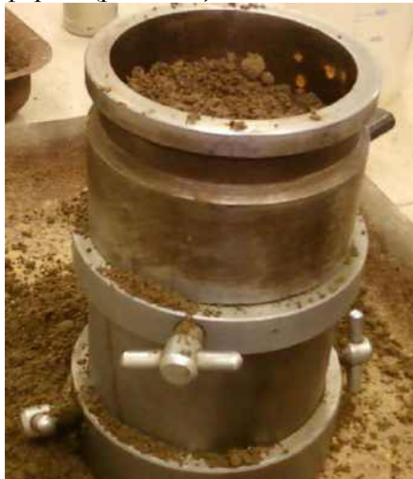
Рис. 4.72. Установка насадки и засыпка грунта третьего слоя
