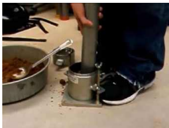
Рис. 4.34. Второй удар ручной трамбовки при тесте А (схема рис. 4.31)
