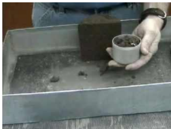
Рис. 4.62. Укладка грунта в бюкс
