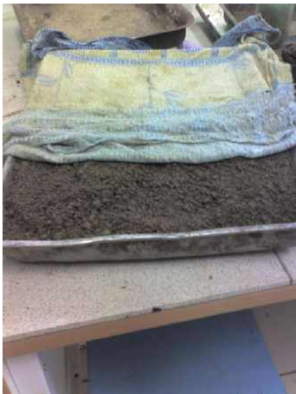
Рис. 4.78. Укрытие грунта влажной тканью с последующим выдерживанием в течение необходимого времени
