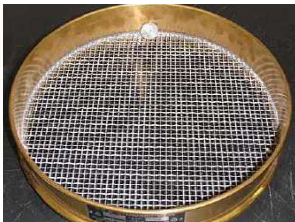
Рис. 4.1. Сито № 4 с ячейкой 4,75 мм
