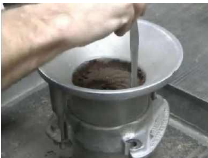
Рис. 4.50. Подрезка грунта у боковой поверхности верхней насадки
