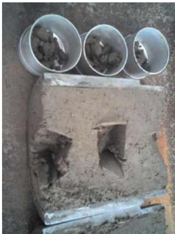
Рис. 4.77 Отбор проб из верхней, средней и нижней частей образца для определения влажности
