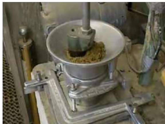
Рис. 4.44. Второй удар полуавтоматической трамбовки при тесте А
