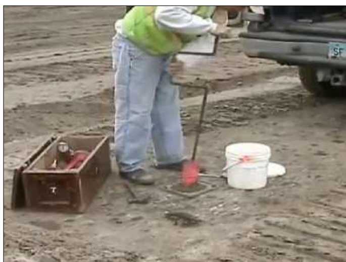
Рис. 4.136. Разработка грунта при устройстве лунки в отверстии дна основания прибора
