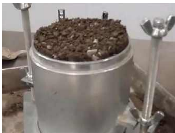
Рис. 4.52. Общий вид выступающей части грунта по завершению теста B
