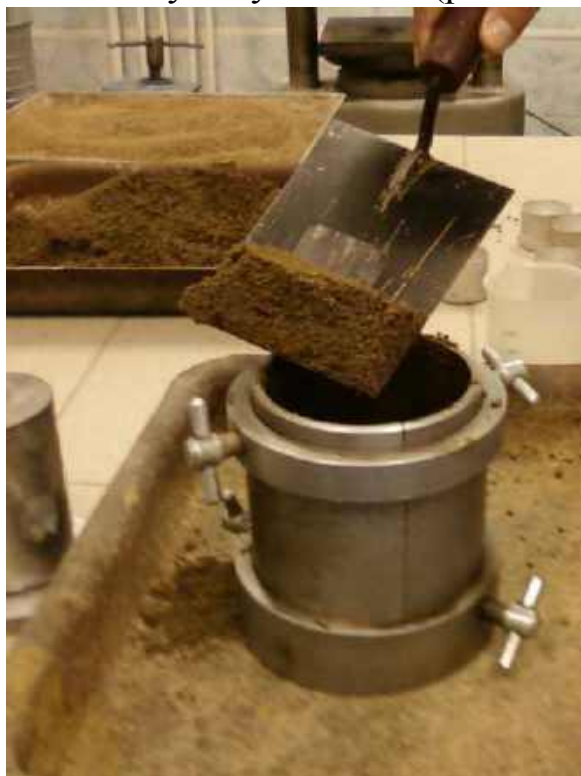
Рис. 4.70. Загрузка грунта в форму слоем толщиной 5 – 6 см
