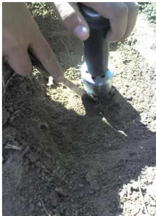
Рис. 4.87. Обрезка грунта вокруг кольца на глубину 5–10 мм ниже края
