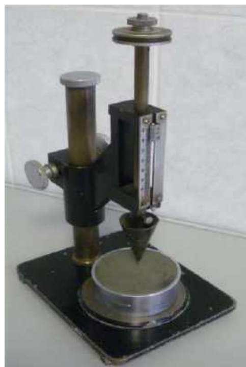
Рис. 3.71. Начальное положение конуса (отсчет по шкале ноль)
