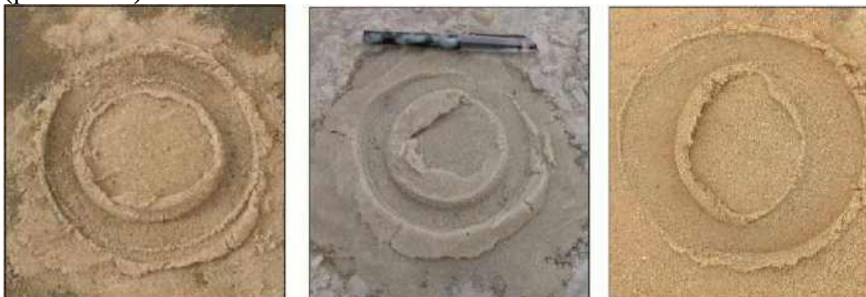
Рис. 4.188. Иллюстрации удовлетворительного контакта опорного кольца с поверхностью
