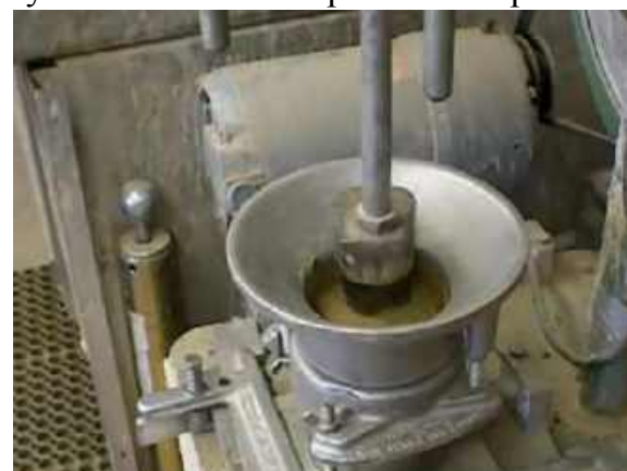
Рис. 4.48. Двадцать пятый (последний) удар трамбовки при тесте А
