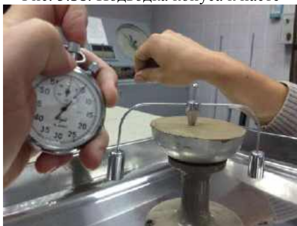
Рис. 3.60. Контроль времени погружения по секундомеру
