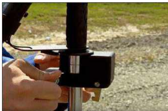
Рис. 4.179. Крепеж механизма сброса и фиксации груза
