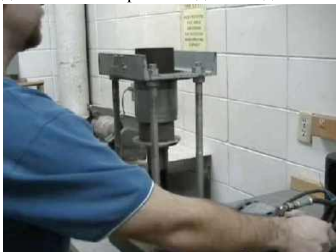
Рис. 4.59. Применение механического выталкивателя для извлечения образца из формы
