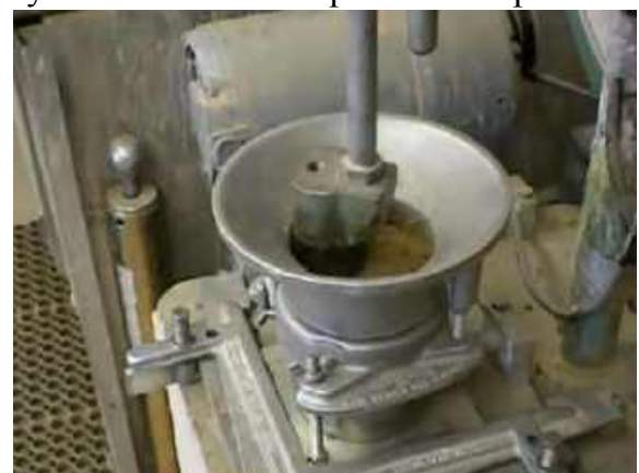
Рис. 4.47. Двенадцатый удар полуавтоматической трамбовки при тесте А
