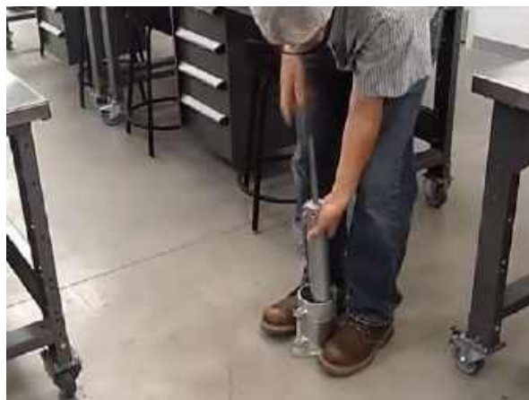
Рис. 4.38. Второй удар ручной трамбовки при тесте B (кольцевая схема)
