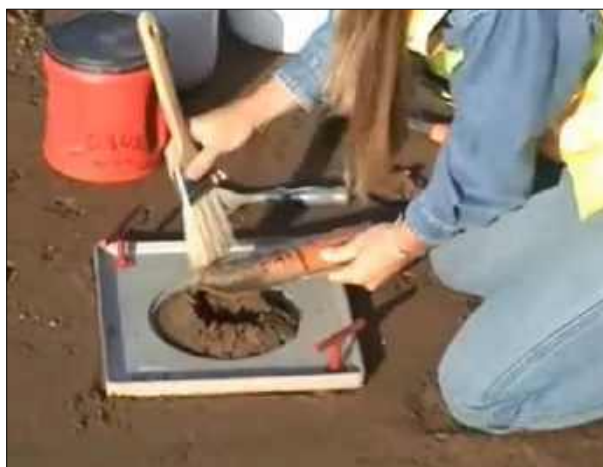
Рис. 4.119. Очистка режущей поверхности бора от налипшего грунта
