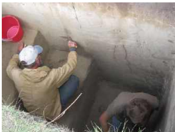
Рис. 3.1. Отбор пробы из зачищенной стенки шурфа
