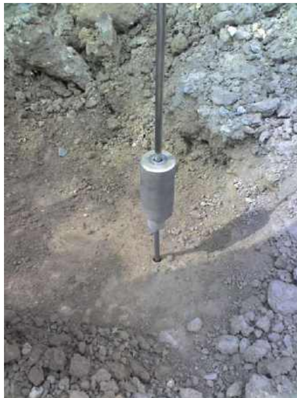
Рис. 4.158. Окончание испытания при погружении прибора на 30 см
