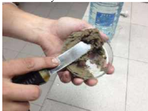
Рис. 3.53. Перемешивание грунто- вой пасты
