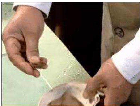
Рис. 3.41. Отбор порции грунта, необходимой для раскатывания
