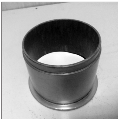
Рисунок 14 – Форма для приготовления лабораторных асфальтобетонных образцов с листом неабсорбирующей бумаги
