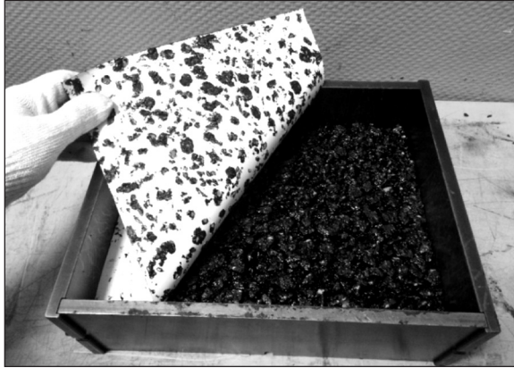
Рисунок 23 – Форма с образцом после проведения уплотнения
