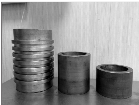
Рисунок 3 – Цилиндрическая форма диаметром 101,0 мм, предназначенная для приготовления асфальтобетонных образцов из крупнозернистых асфальтобетонных смесей, и два вкладыша
