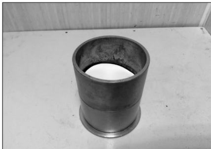
Рисунок 16 – Форма для приготовления лабораторных асфальтобетонных образцов с листом неабсорбирующей бумаги над смесью
