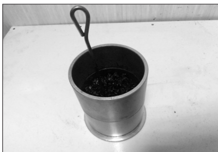
Рисунок 15 – Форма для приготовления лабораторных асфальтобетонных образцов со смесью и металлическим стержнем
