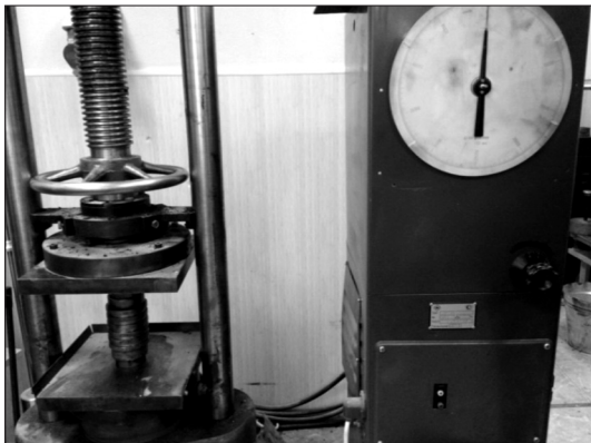
Рисунок 6 – Уплотнение асфальтобетонной смеси на прессе П-50
