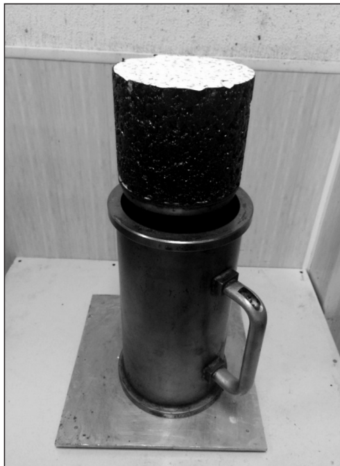
Рисунок 32 – Извлечение асфальтобетонного образца при помощи выжимного устройства
