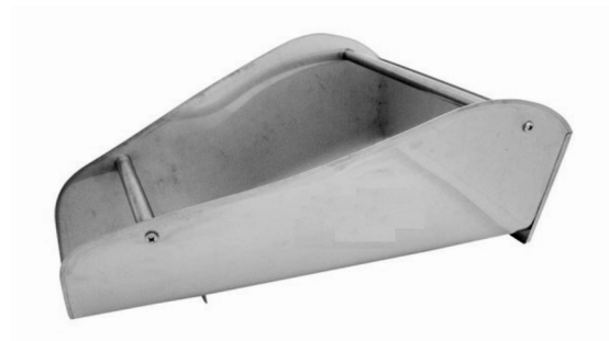
Рисунок 30 – Металлический лоток для засыпки асфальтобетонной смеси в форму
