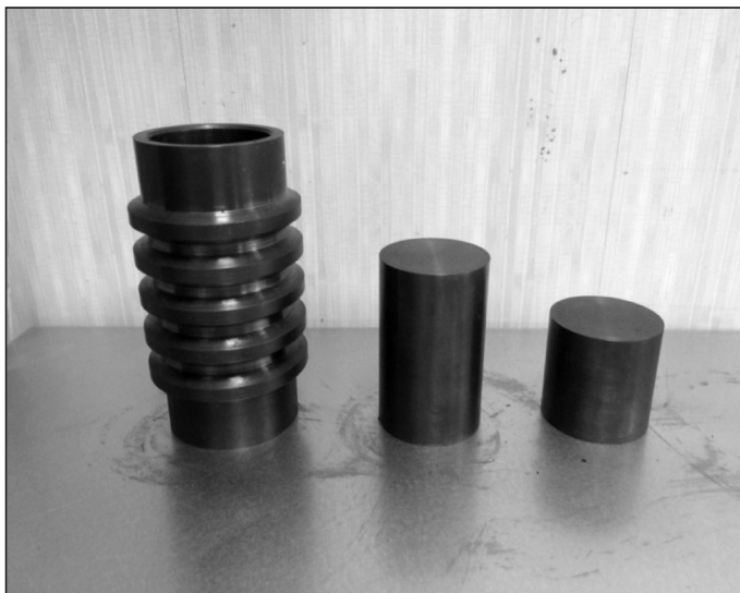
Рисунок 1 – Цилиндрическая форма диаметром 50,5 мм, предназначенная для приготовления асфальтобетонных образцов из песчаных смесей, и два вкладыша
