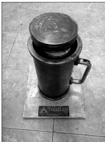
Рисунок 29 – Стальная форма с вкладышами для приготовления образцов диаметром 150 мм
