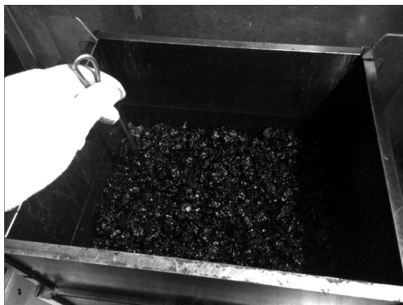
Рисунок 22 – Штыкование асфальтобетонной смеси
