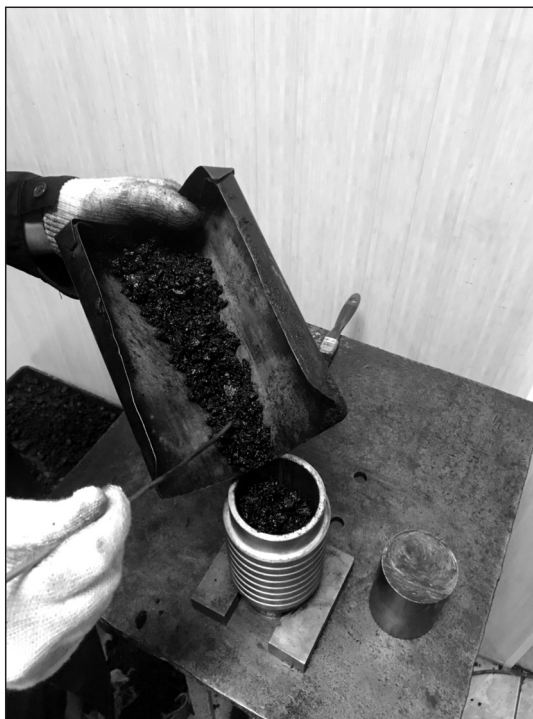
Рисунок 4 – Приготовление асфальтобетонного образца
