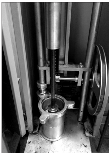
Рисунок 17 – Форма для приготовления лабораторных асфальтобетонных образцов на стойке уплотнителя Маршалла
