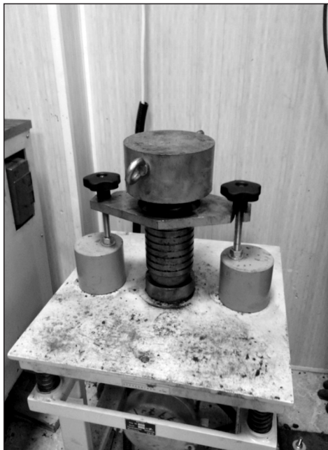
Рисунок 8 – Виброплощадка для предварительного уплотнения многощебенистых смесей
