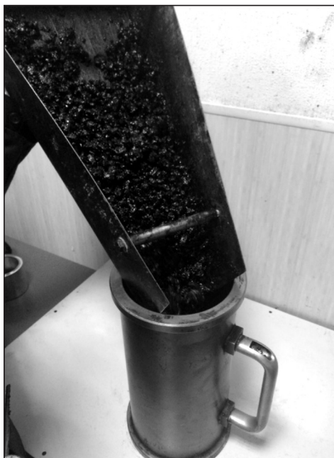
Рисунок 31 – Засыпка асфальтобетонной смеси в форму при помощи специального лотка за один прием
