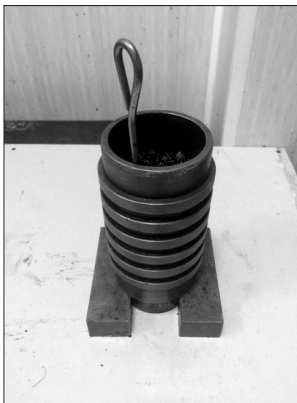
Рисунок 5 – Металлический стержень для штыкования в форме со смесью
