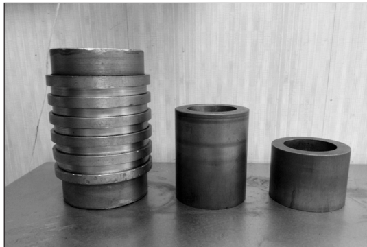
Рисунок 2 – Цилиндрическая форма диаметром 71,4, предназначенная для приготовления асфальтобетонных образцов из мелкозернистых и щебеночно-мастичных асфальтобетонных смесей, и два вкладыша
