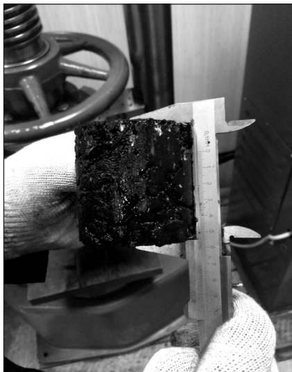
Рисунок 9 – Измерение асфальтобетонного образца штангенциркулем
