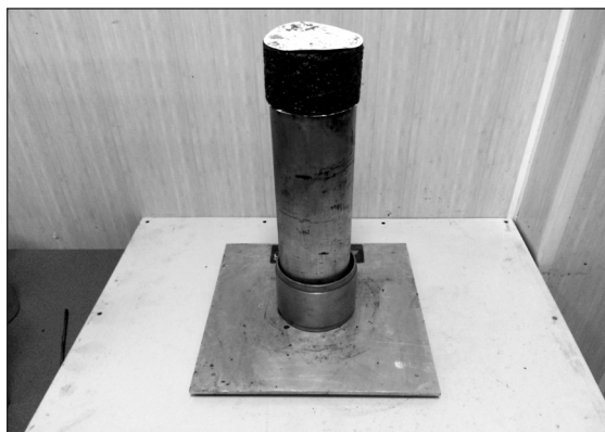
Рисунок 18 – Извлечение образца из формы
