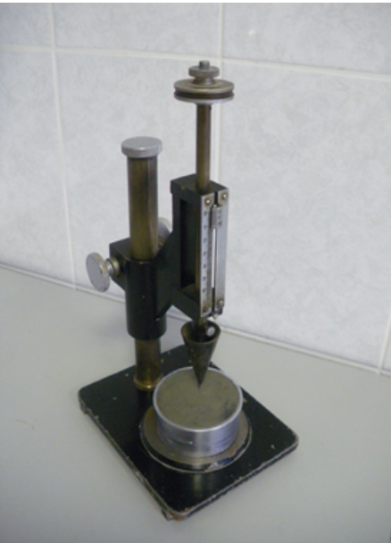
Рис. 1. Конус (пенетрометр) П.О. Бойченко. Общий вид
